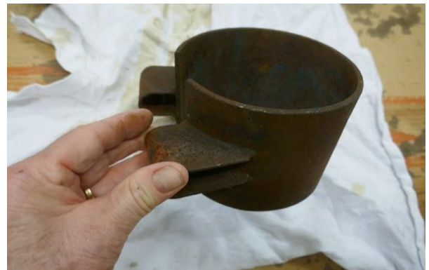
Ruostunut pyörätelineen kiinnityskaulus ennen happokäsittelyä
