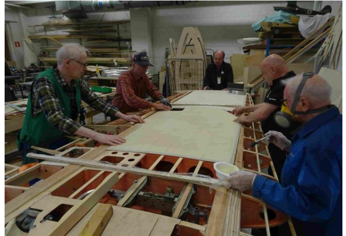
Oikean siiven yläpintaa verhoillaan vanerilla
