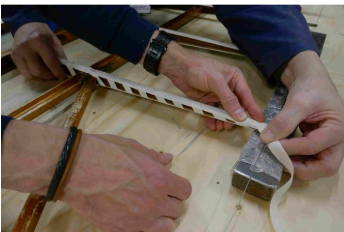
Verhoiluun liittyviä nauhoja kiinnitetään oikean korkeusperäsimen kaariin
