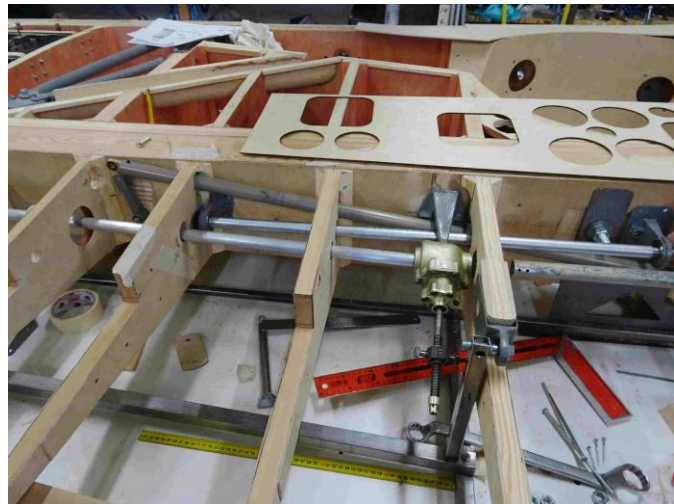
Siiven sisään asennettuja laskutelineen ja siivekkeiden käyttötankoja
