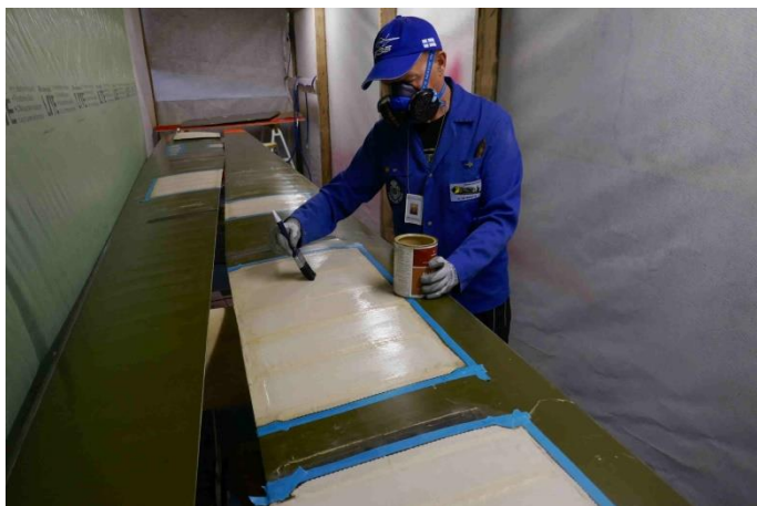
SM-1 helikopterin roottorilavan uusien kankaiden kiristyslakkaus käynnissä.
