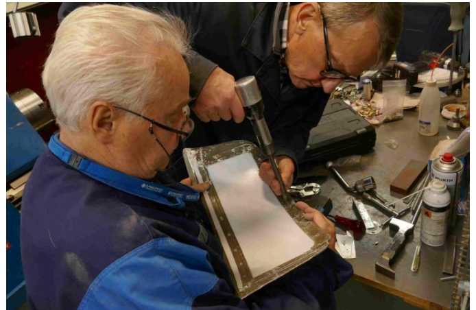
Suojakalvoista pleksilasia asennetaan korjattuun tuulilasin raamiin
