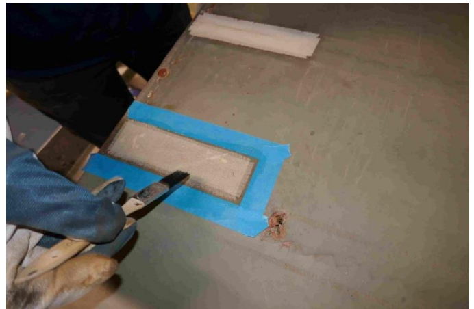
Vasemman korkeusperäsimen reikiä paikataan kangaspaikalla
