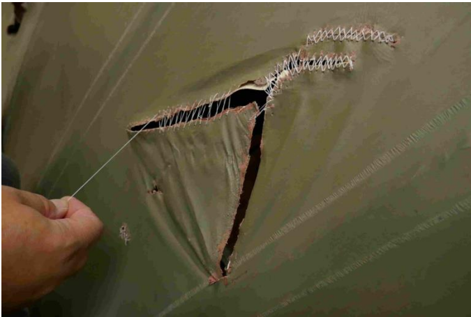
Vasemman siiven repeämää ommellaan umpeen
