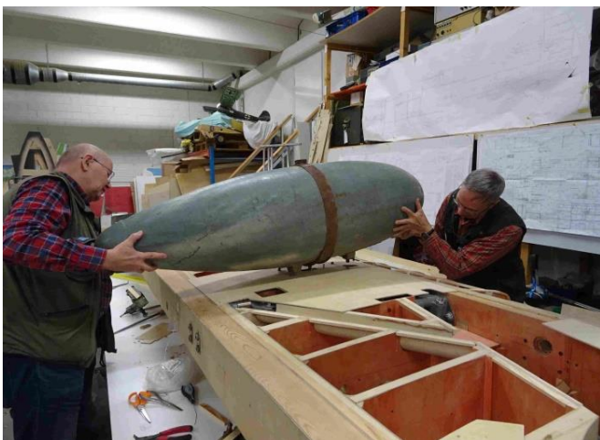
Ripustimen toimivuutta testataan
