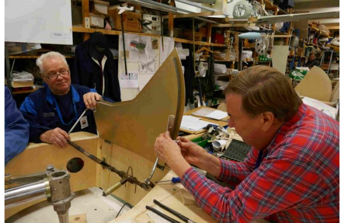
Koesiiven pyöräaukon luukkuja sovitetaan oikean siiven pyöräaukkoon
