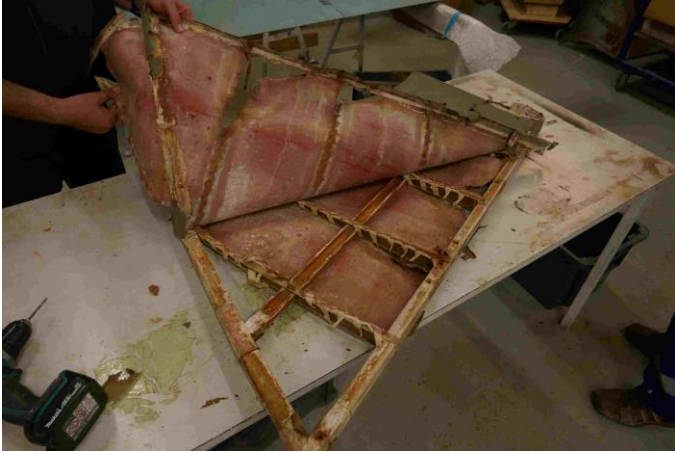
Oikeanpuoleisen korkeusperäsimen verhoilua riisutaan
