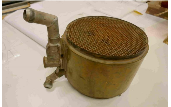
Löytynyt alkuperäinen moottorin öljynjäähdytin
