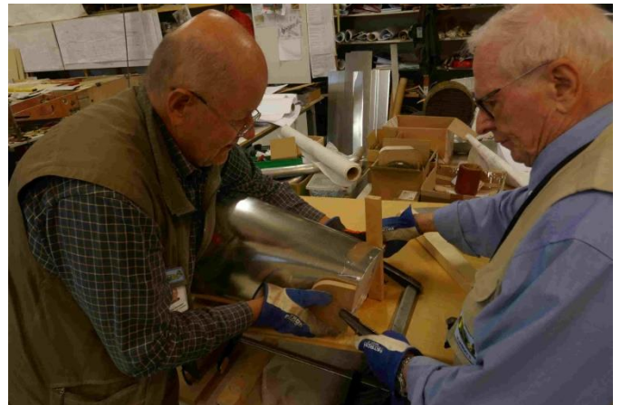
Öljynjäähdyttimen torviosaa muokataan muokauslestiä vasten
