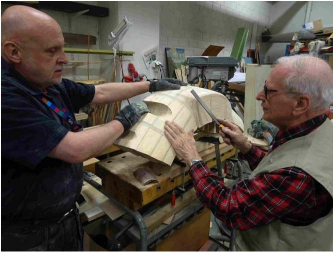
NACA-renkaan yläosan muokkauslestiä tehdään
