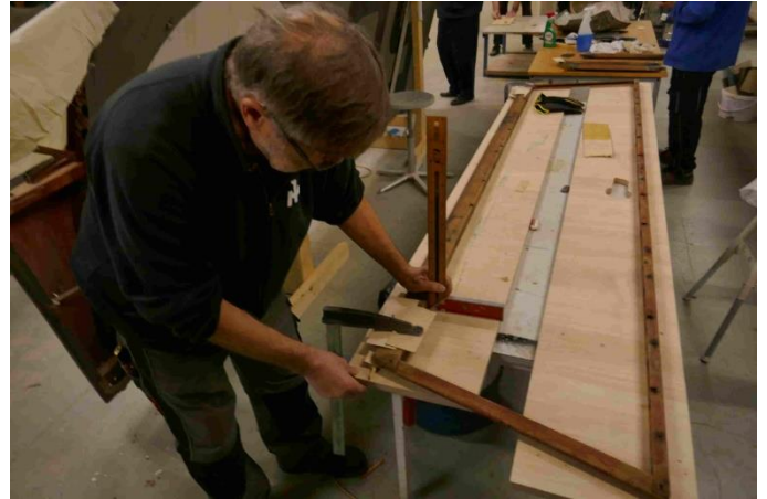
Korkeusvakaajan märkiä johto- ja jättöreunan listoja kiinnitetään pöytätasoon suoristumaan
