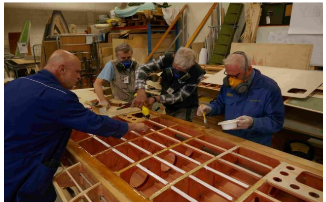
Vasemman siiven alapintaan sivellään liima verhoiluvanerin kiinnittämiseksi
